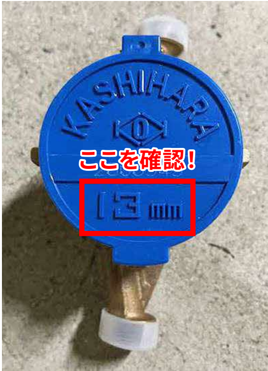
水道メーター（量水器）本体
